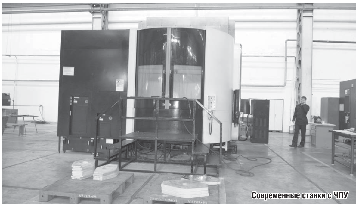
За каждой шторкой – отдельная кабинка для станка. Возле каждого станка – вытяжка.
